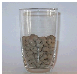
Bentonit før vandkontakt
